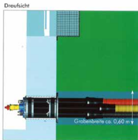
Abb. 2: Einbau Quadro-Sicura® Nova
