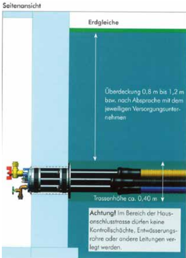
Abb. 1: Einbau Quadro-Sicura® Nova
