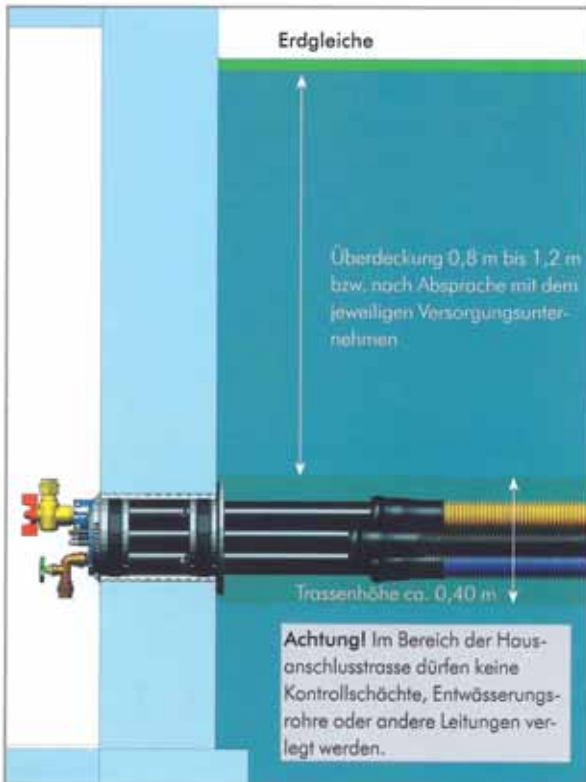
Abb. 1: Einbau Quadro-Sicura® Nova
